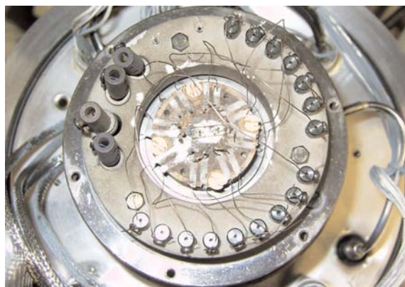
Abb. 1: Kryostat für Wärmeleitfähigkeitsuntersuchungen bis 800 K.
